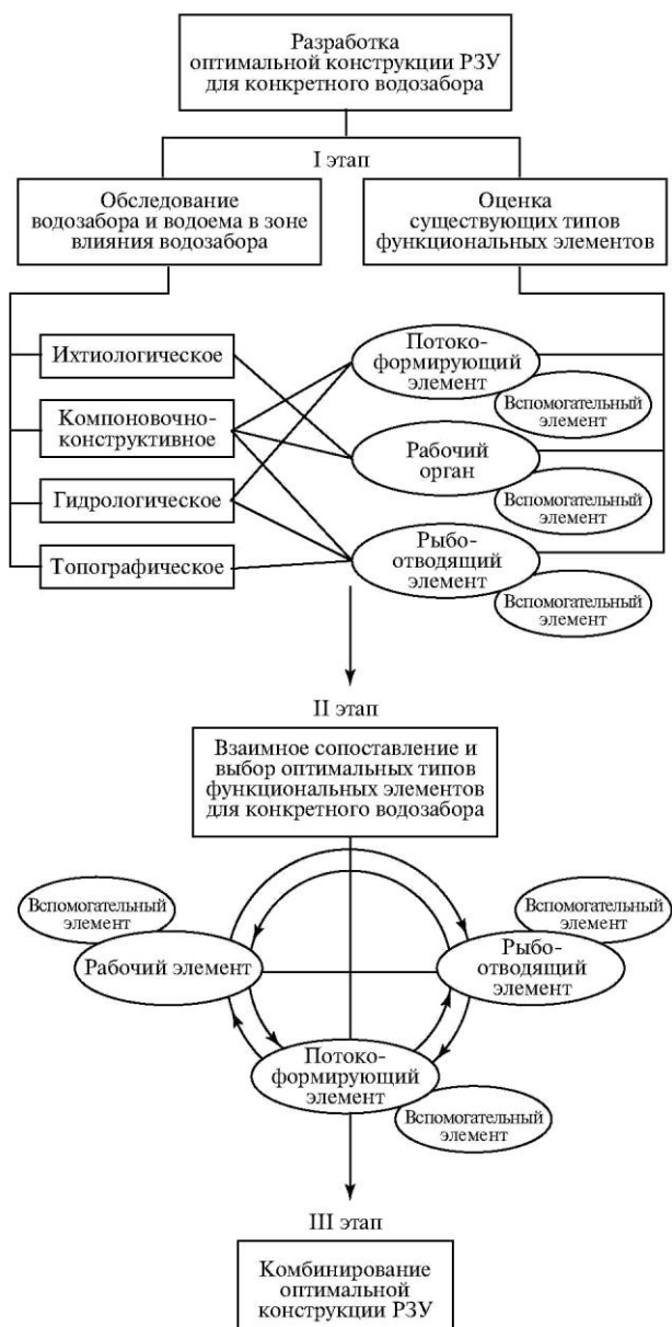
Рис. 5.48. Алгоритм выбора оптимальной конструкции РЗУ для конкретного объекта
