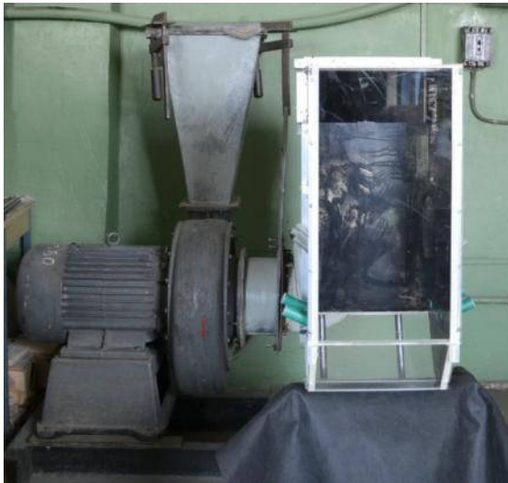
Рис. 15. Общий вид экспериментальной установки по изучению топочной аэродинамики котла № 1.
