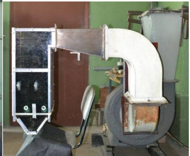
Рис. 15. Общий вид экспериментальной установки по изучению топочной аэродинамики котла № 1.
