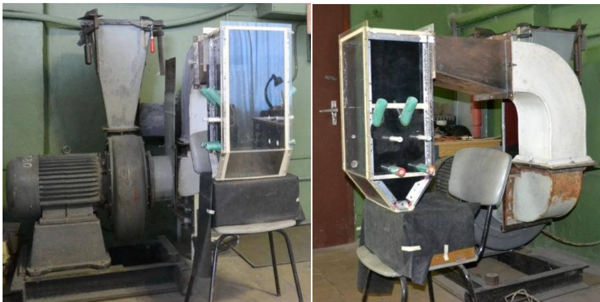
Рис. 4. Общий вид экспериментальной установки по изучению аэродинамики топки котла №2
