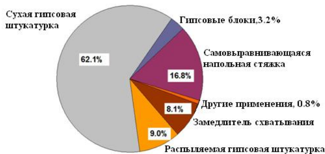
Рис. 3. Утилизация гипса установок сероочистки в строительной отрасли в Европе (ЕС-15) в 2009 г. (общая утилизация составила 10,6 млн. тонн) [1]
