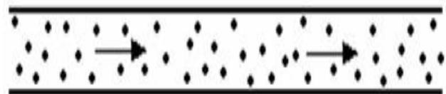
Рис. 1. Пневмотранспорт низкоконцентрированной пневмосмеси во взвешенном состоянии
