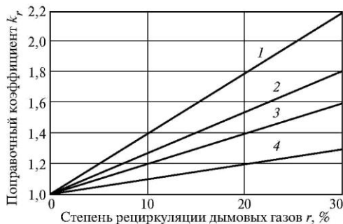
Рис. 1.53. Влияние различных способов подачи газов рециркуляции в топку газомазутных котлов на содержание БП в продуктах сгорания: 1 — подача газов в дутьевой воздух; 2 — в щлицы под горелками; 3 — в щлицы напротив горелок; 4 — в подтопки
