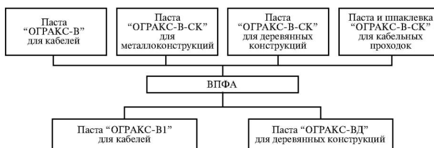
Рис. 7.27. Огнезащитные материалы «ОГРАКС» на основе высокомолекулярного полифосфата аммония (ВПФА)
