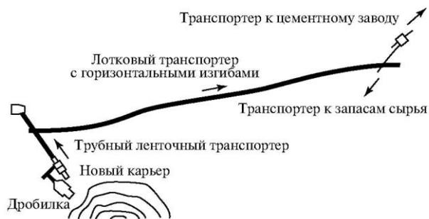
**Рис. 3.11. Схема комбинированной конвейерной установки:**
