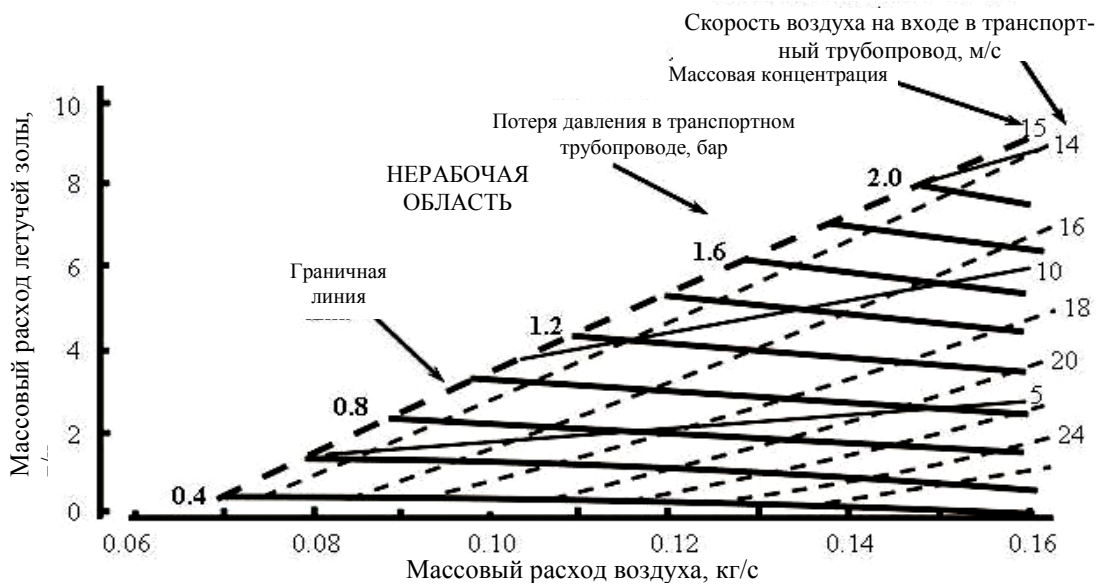
Рис. 5. Транспортные характеристики крупной летучей золы с приведением скоростей воздуха на входе в транспортный трубопровод
