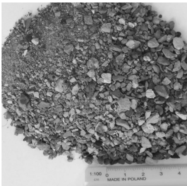
Рис. 4. Донная зола при непроектных эксплуатационных условиях работы котла и вспомогательного оборудования
