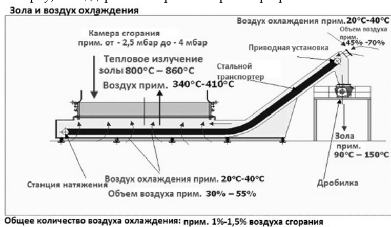
Рис.4. Базовый принцип системы сухого удаления топочной золы
